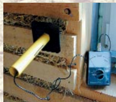
Feuchtemessung an Strowänden
